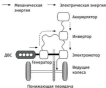
▼ Последовательная гибридная схема
